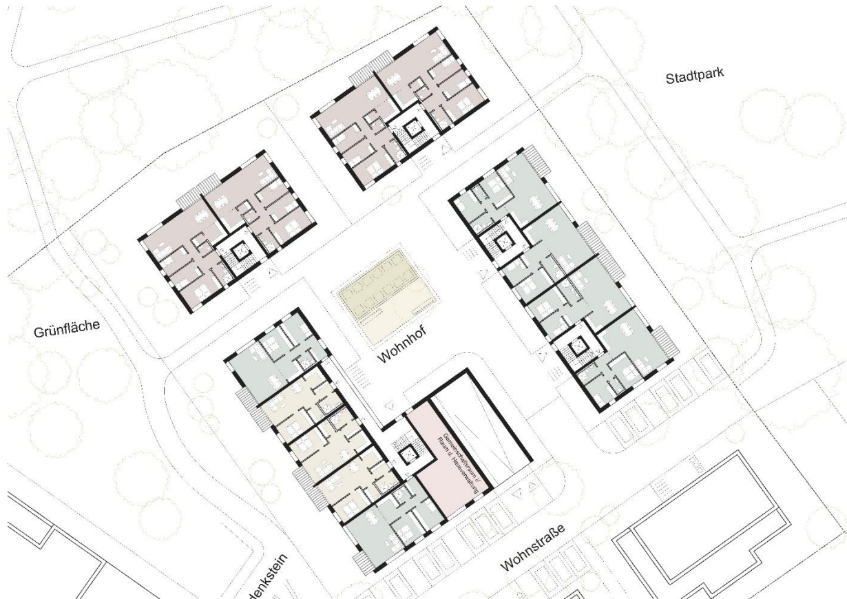
Abb. 32: Vorentwurf | Bauabschnitt 02, Erdgeschoss © LECKE ARCHITEKTEN
