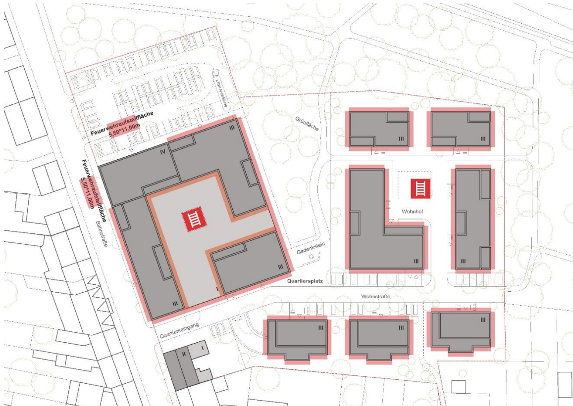
Abb. 26: Rahmenplanung | Rettungskonzept © LECKE ARCHITEKTEN
