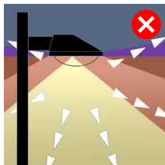
Mastleuchte ohne Lichtlenkung
