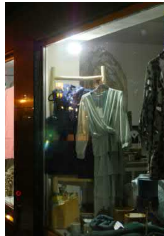
Durch Montageposition und Ausrichtung der Strahler werden die Produkte im Schaufenster nicht gezielt angestrahlt. Stattdessen wird der öffentliche Straßenraum beleuchtet.
