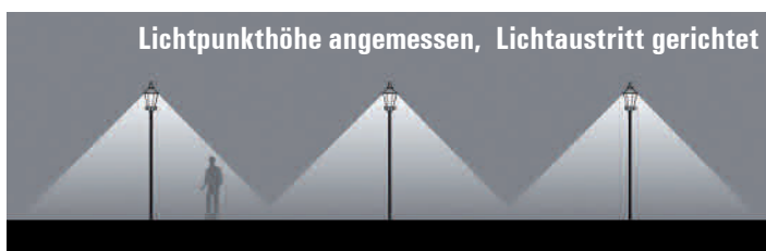
Darstellung Gleichmäßigkeit der Lichtverteilung anhand veränderter Lichtpunkthöhen und Lichttechnik
