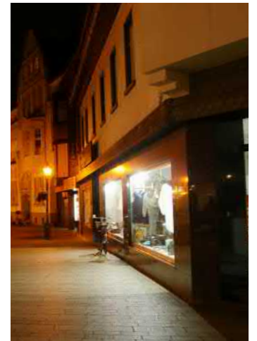
Durch Montageposition und Ausrichtung der Strahler werden die Produkte im Schaufenster nicht gezielt angestrahlt. Stattdessen wird der öffentliche Straßenraum beleuchtet.
