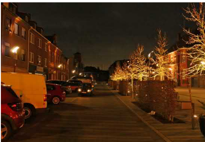
Auf dem Kaiserplatz verursacht nicht nur die Funktionalbeleuchtung mit Indirekttechnik Lichtverschmutzung, auch die Baumanstrahlung über Bodeneinbaustrahler sorgt, insbesondere in der laubfreien Jahreszeit, für einen Lichteintrag in den Nachthimmel.
