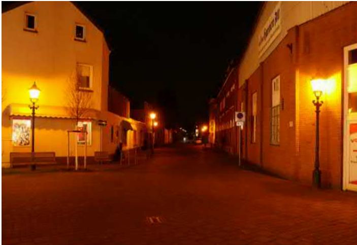
Freistrahkende Lichtquellen geben das Licht ohne Lichtlenkung in den oberen Halbraum ab und tragen so zur Lichtverschmutzung bei. Ein Großteil des Lichtes erreicht nicht die Nutzebene -> Ineffizienz
