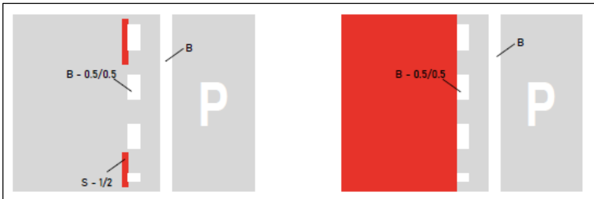
Abbildung 6: Markierungsvarianten neben Parkständen [Quelle: Leitfaden Fahrradstraße, AGFS]
